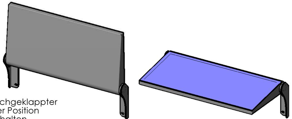
Die Tischplatte wird in hochgeklappter wie auch in abgeklappter Position unter Federspannung gehalten und wird in ihrer Bewegung in beide Richtungen gedämpft.
