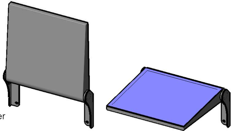
Die Tischplatte wird in hochgeklappter wie auch in abgeklappter Position unter Federspannung gehalten und wird in ihrer Bewegung in beide Richtungen gedämpft.
